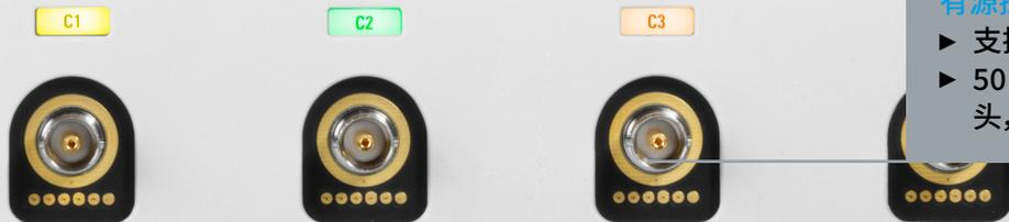
⚠ C1-C4: 1MΩ: ≤ 150V RMS, ≤ 200V pk; 50Ω: ≤ 5V RMS
